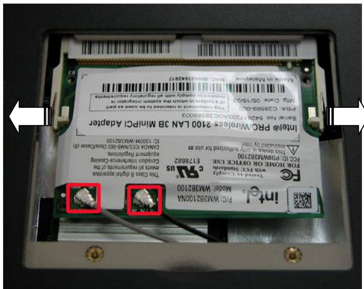
Fig. 9 Wireless LAN & MCD Modem Module
