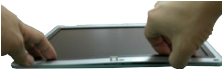
Fig. 28 Removing the LCD Bezel
